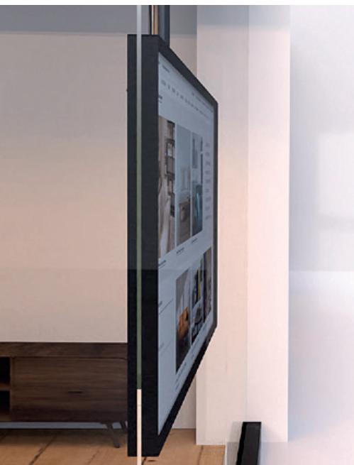
Through-Glass-Touch erlaubt den Einsatz von Touchscreens hinter separaten Glasscheiben bis zu 6mm Dicke.
